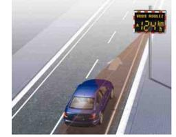
$$V \text{ mesurée} = V \text{ réelle} \times \cos \theta$$
